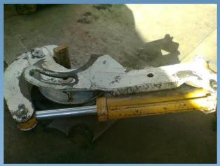
Reparación completa de llave hidráulica tipo caimán
